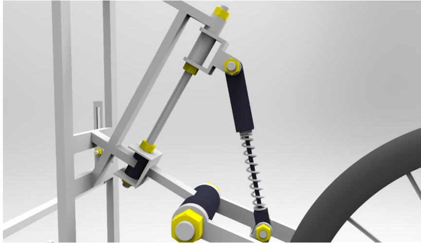
Hình 9: Kết cấu lò xo ép
