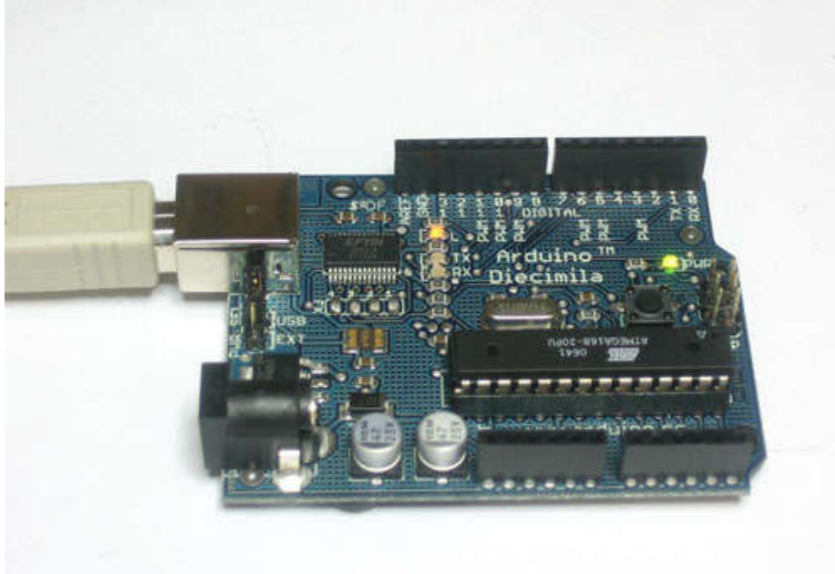
Hình 28. Nối cáp FTDI vào bo mạch Arduino
